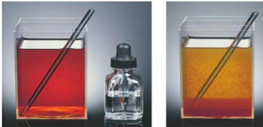
Gambar 121 Koagulasi besi(III)oksida, diperoleh dengan menambahkan  $\text{FeCl}_3$  ke air panas.
