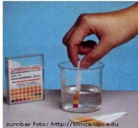
Gambar 106 Pengukuran pH larutan menggunakan kertas indikator universal (<http://www.google.com>)
