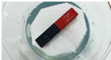
Gambar 124. Magnet Batang yang diapungkan
