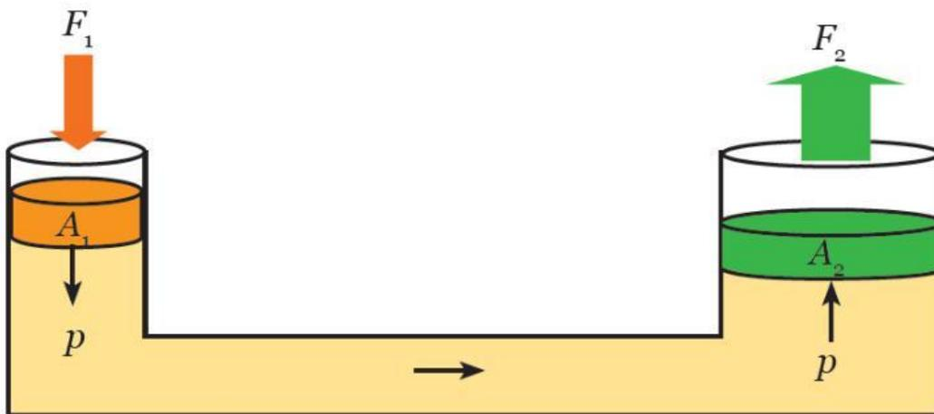
Gambar 55. Model Dongkrak Hidrolik
