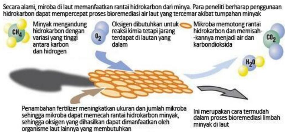
Gambar 139. Proses bioremediasi limbah minyak menggunakan mikroorganisme (Sumber: Lawrence Berkeley National Lab)
