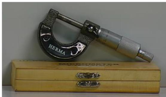
Gambar 5. Mikrometer Sekrup
